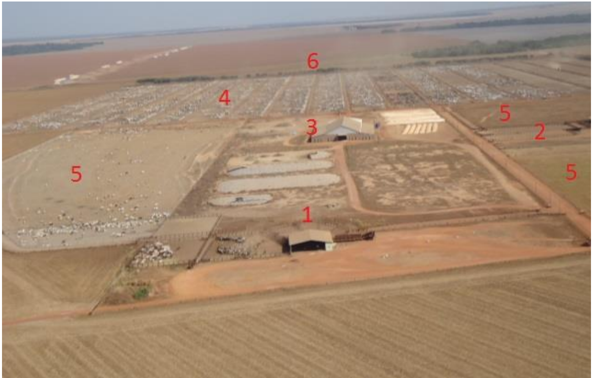
Figura 4. Vista aérea do confinamento (CLV) 1 e 2 - currais de manejo; 3 – fábrica de ração; 4 – currais de confinamento; 5 – pastos da tropa e animais de rejeito; 6 – lagoas de decantação. Fonte: Milton Perpétuo (2014).
