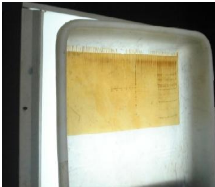
Figura 4. Revelação do Gel de policrilamida na técnica de microssatélites
