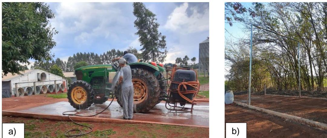
**Figura 3.** Sistema de desinfecção de veículos, a) Mangueira de desinfecção b) Arco de desinfecção. (Fonte: arquivo pessoal)
