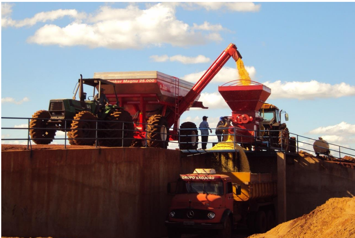
Figura 5. Transferência dos grãos da colheitadeira, quebra do grão e acréscimo do benzoato de sódio para confecção de silagem de grão úmido.
