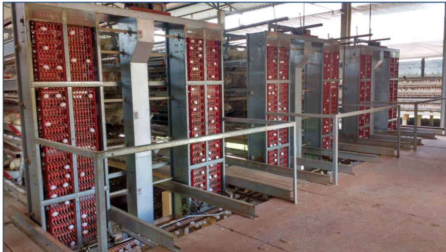
Figura 4. Sistema de coleta de ovos automatizada.
