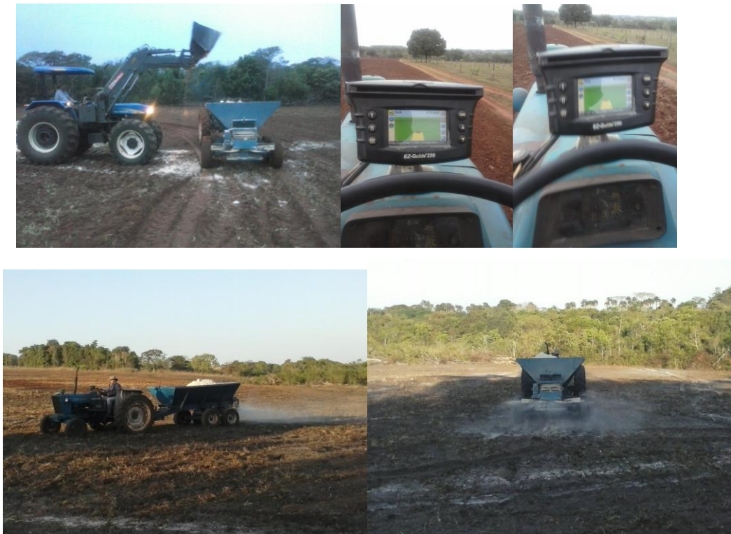
Figura 9. Distribuição de calcário e gesso agrícola com uso de GPS.
