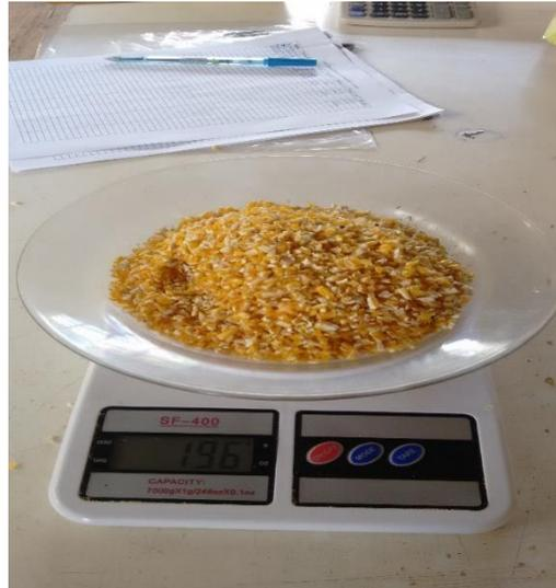
Figura 7. Pesagem da amostra para a análise de granulometria.
