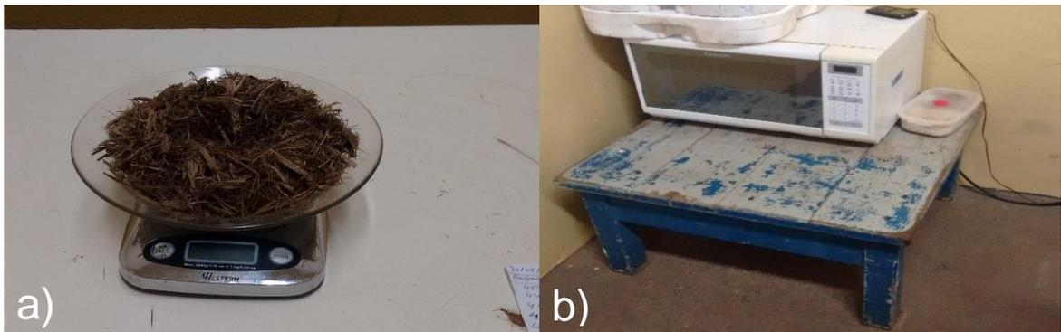
Figura 5. Análise de matéria seca: (a) Pesagem da amostra para determinação da matéria seca (MS) (b) Secagem da amostra.
