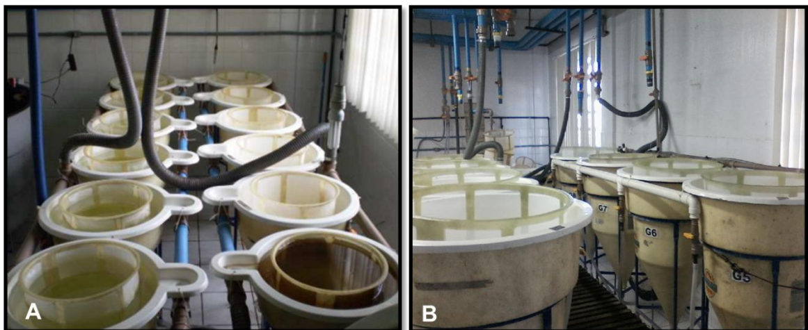
Figura 13. (A) Incubadoras do tipo cilindro-cônica capacidade 56L; (B) Incubadoras do tipo cilindro-cônica capacidade 200L. LAPAD/UFSC/2013.
