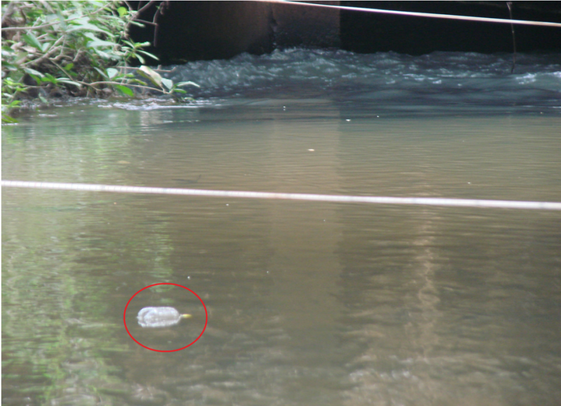
Foto 3 - Determinação da velocidade da água com o uso de flutuador.
