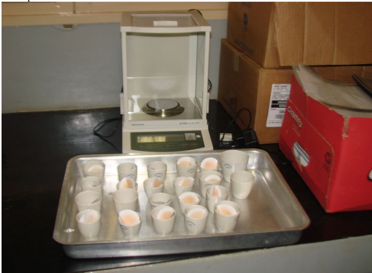
Foto 11 - Balança analítica e filtros utilizados para determinar a concentração de sólidos em suspensão.
