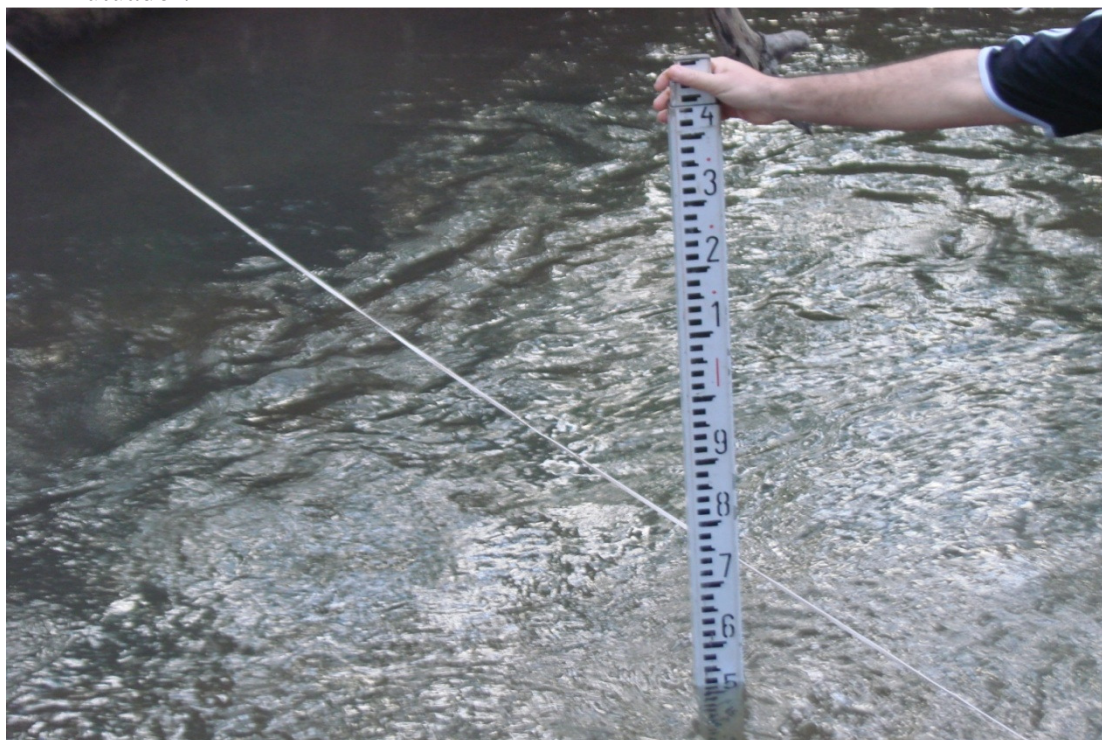
Foto 4 - Determinação da profundidade com régua para medição da vazão pelo método do flutuador.
