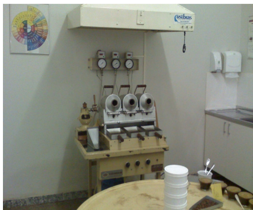
Figura 15: Máquina de torrefação e moagem do café, na análise laboratorial. Dados da pesquisa, 2010.
