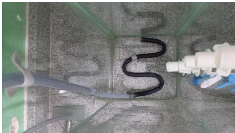
Figura 5 – Mangueira porosa localizada no fundo do reator.
