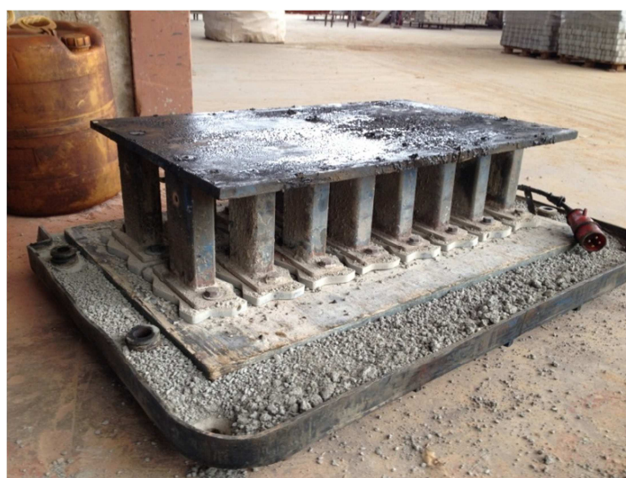
Figura 50 - Fôrma superior de unistein sobre bandeja de madeira e forma inferior.
