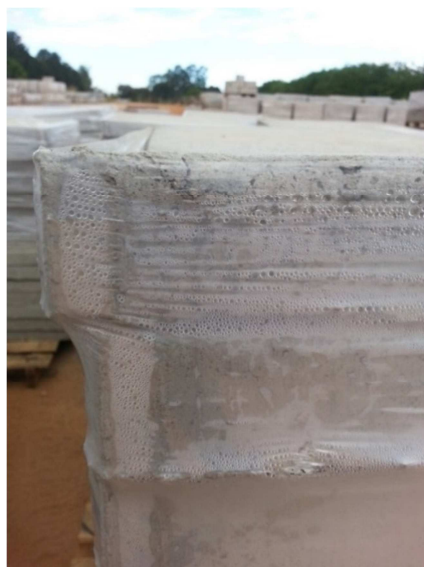
Figura 59 – Filme plástico stretch e detalhe para a retenção da umidade.
