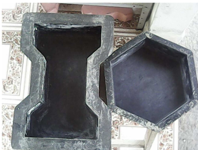
Figura 8 - Forma de plástico utilizada no processo dormido (PEC FORMAS, 2013).
