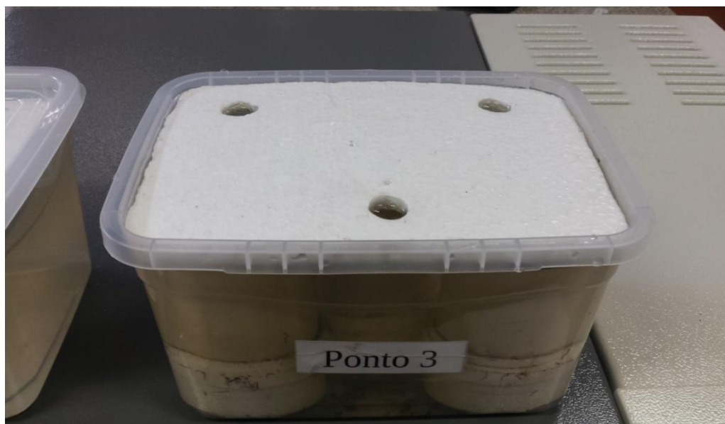
Figura 3.6 – Vista superior de um dos reatores, mostrando as 3 aberturas feitas para as aferições de oxigênio dissolvido e temperatura.
