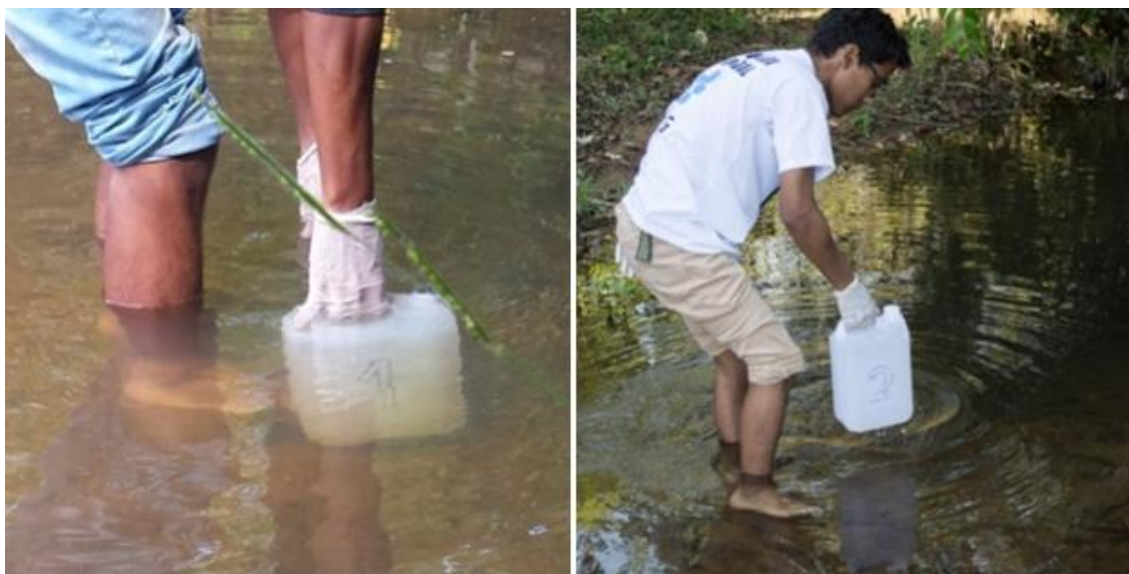
Figura 3.4 – Coleta de água do corpo hídrico com galão de polipropileno.
