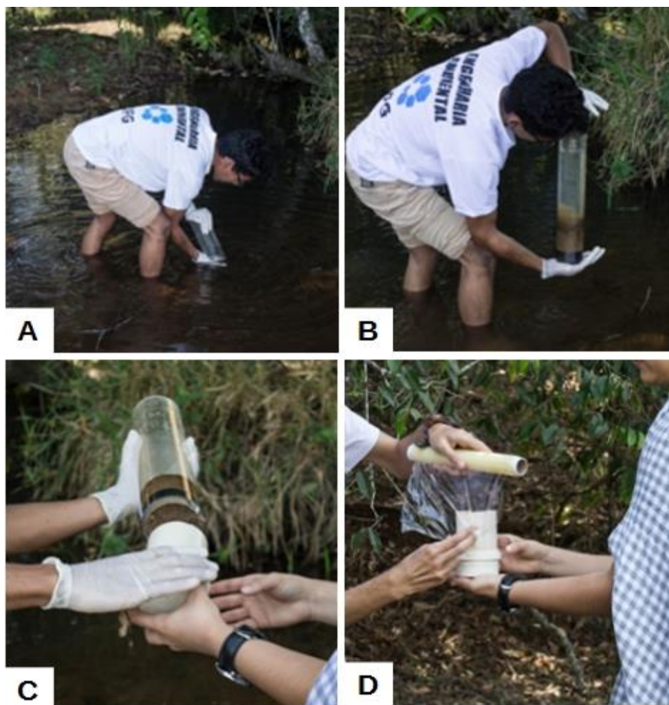
Figura 3.3 – Coleta de sedimento para análise de demanda bentônica. A figura A) mostra a inserção do tubo de vidro no sedimento; a B) apresenta a retirada do tubo com o sedimento; a C) ilustra a transferência do conteúdo para o core e; a D) apresenta a cobertura com plástico filme do core com o material.
