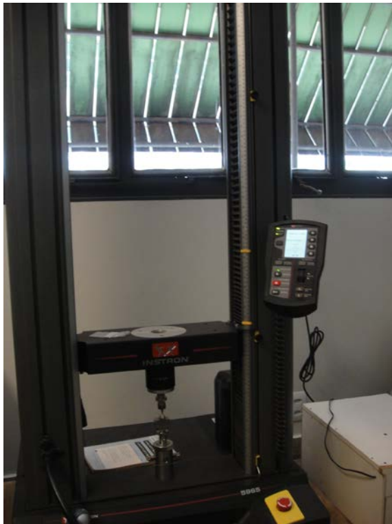
Figura 7. Teste de resistência à tração diametral (Instron).
