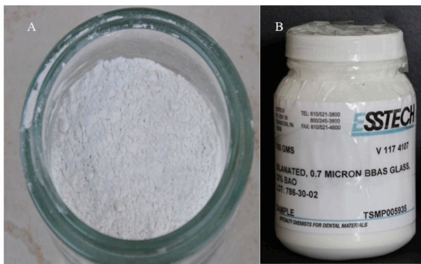
Figura 2. Partículas de carga: A - Pó de fibra de vidro ; B – Silicato de bário
