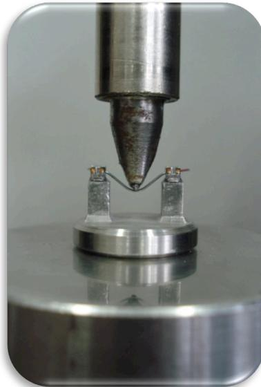
**Figura 6.** Ponta ativa Instron. Deflexão do fio durante leitura da máquina da carga imposta ao fio. Distância de carga foi definida em 4 mm de ativação.
