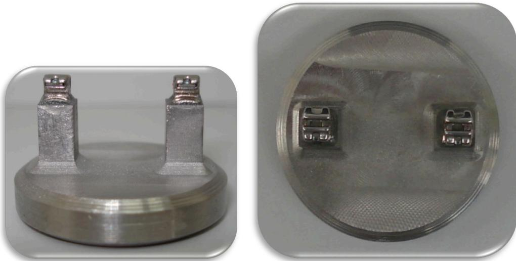
**Figuras 4 e 5.** Porta Amostra, vistas Lateral e Superior. Distância interbráquetes de 10 mm.
