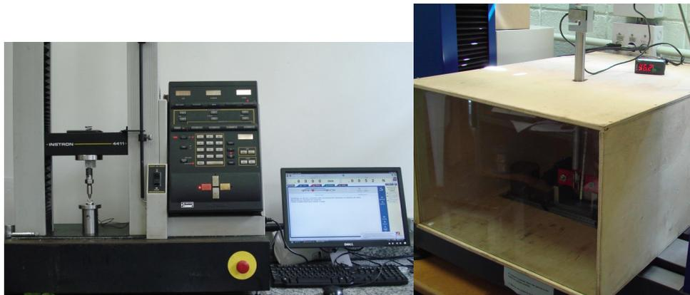
**Figura 3.** Máquina de Ensaio Universal Instron. Composta por: mesa, ponta ativa, máquina de comando e computador adaptado para processamento dos dados obtidos. Caixa com termômetro para controle de temperatura.
