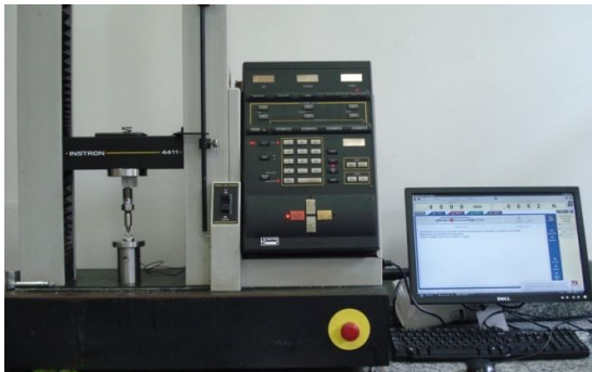
Figura 5. Máquina de Ensaio Universal Instron
