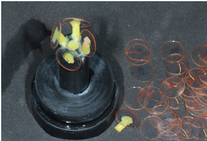
Figura 3. Padrões afixados nos sprues de cera na base do anel de injeção.
