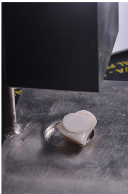
Figura 7. Conjunto formado por dente, pasta de prova e disco cerâmico sob peso de 200 g.
