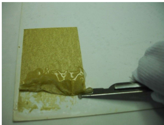
Figura 27 – Retirada de fita adesiva utilizando cola metil celulose diluída em água destilada, s.d.
