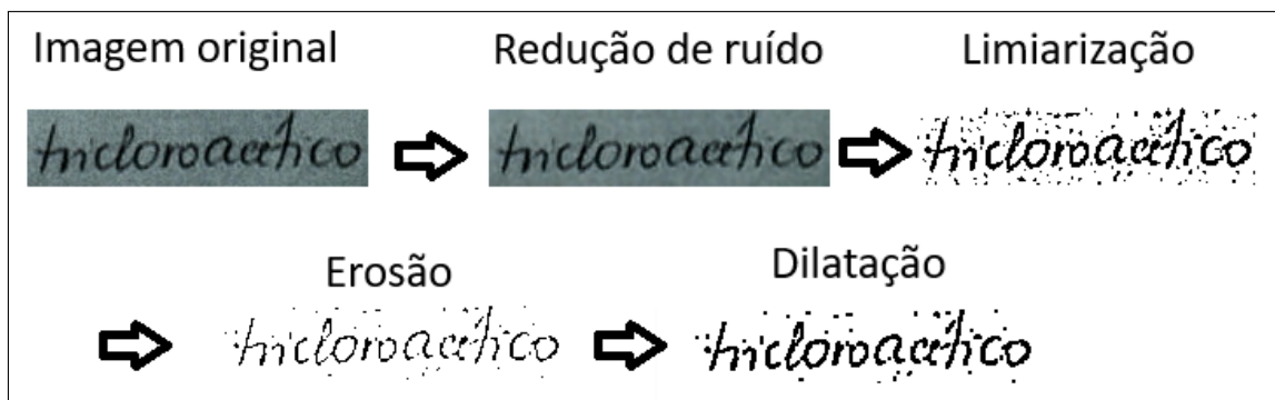
Figura 5.5: Exemplo da abordagem de pré-processamento usada para a etapa de reconhecimento de texto
