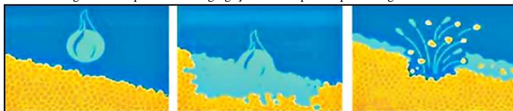
Figura 3 - Esquema da desagregação do solo pelo impacto da gota de chuva
