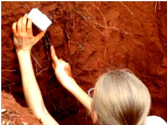
Figura 33: Foto – Coleta de amostra indeformada em caixa retangular de papel cartão branco nas dimensões 12x7x6.
