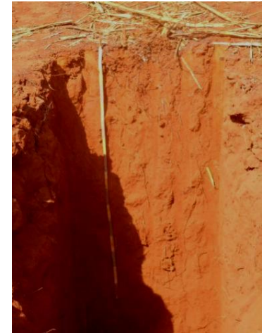
Figura 30: Foto - Perfil de solo LVdf, compactado, perfil 2B.
