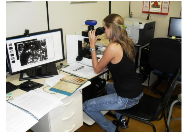
Figura 36: Foto – Laboratório de micromorfologia de solos. Observação de lâmina delgada de solos em microscópio petrográfico óptico binocular.
