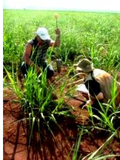
Figura 34: Foto – Realização de ensaio de resistência mecânica à penetração no solo.
