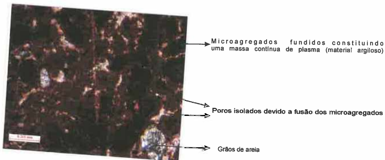
FIGURA 54 - Zonas de intensa fusão dos microagregados, observadas nos volumes alterados pelo manejo do sistema plantio direto, as quais aparecem junto aos microagregados arredondados.
