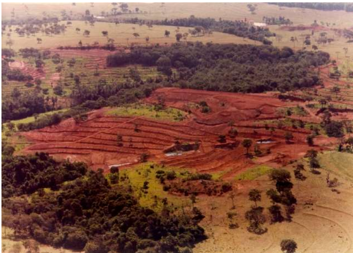
Figura 3 – Técnica de terraceamento utilizada às margens do Ribeirão Abóbora para recuperação do solo. Fonte: RIO VERDE, 2016.
