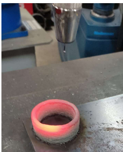
Figura 07 – Peça cilíndrica, em Inconel 625, com 7,0 cm de diâmetro, construída com 30 camadas pelo processo MADA sem o resfriamento forçado.
