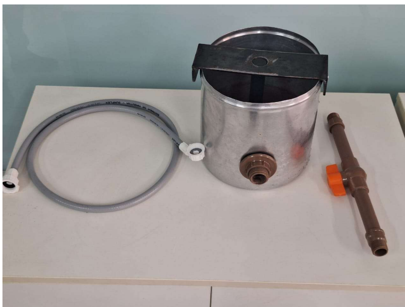
Figura 3. Dispositivo Jominy de baixo custo desenvolvido
