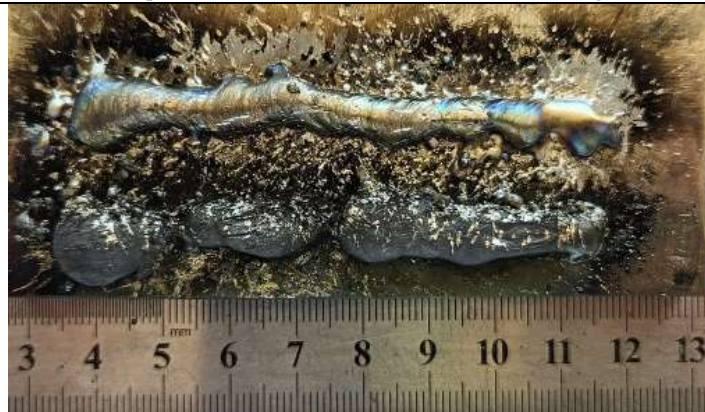
Figura 1. Cordão de solda Convencional que não atendeu aos critérios.
