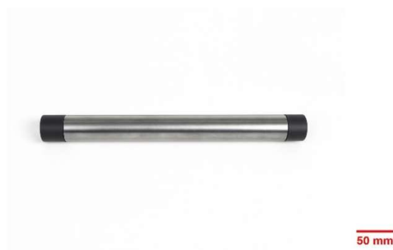
Figura 7: Tubo e plugues do ensaio
