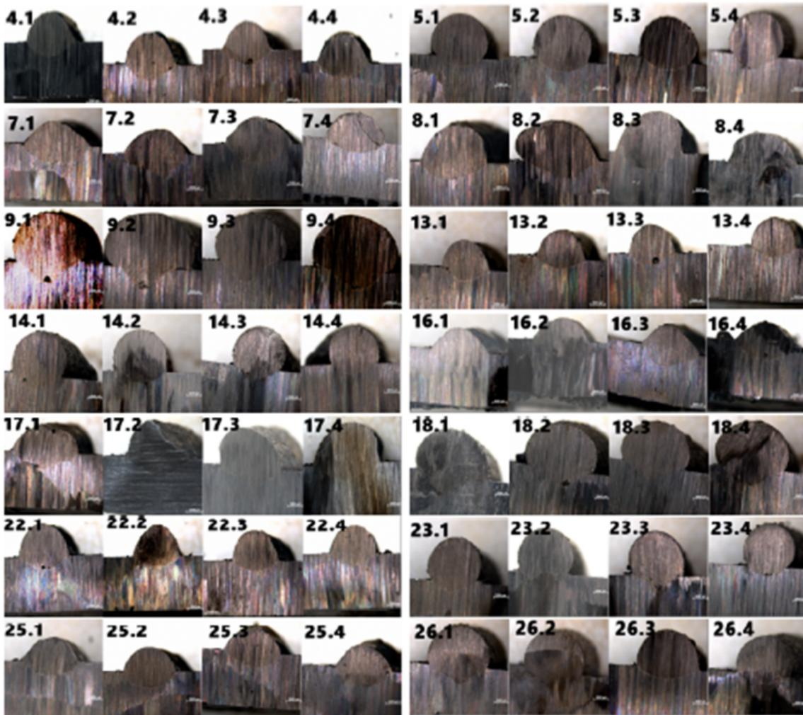
Figura 4. Seção transversal dos cordões de solda selecionados
