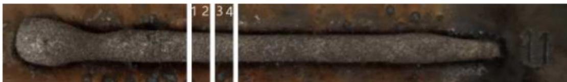
Figura 1. Posição dos cortes realizados nos cordões
