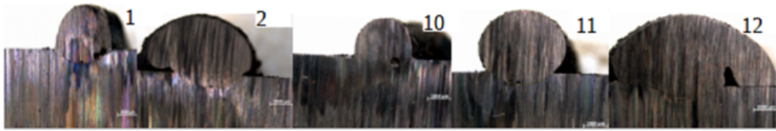
Figura 3. Defeito apresentado em alguns cordões de soldas, como porosidade e baixa penetração
