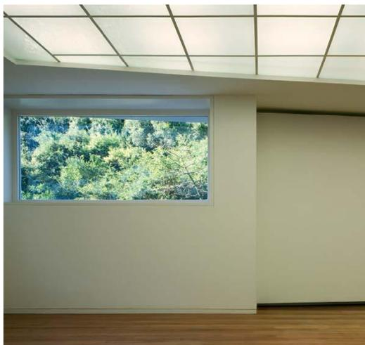
**Figura 203: As fendas no alto e no pé da parede são saídas de ar condicionado. Fonte: <http://casa.abril.com.br/materia/encontro-de-estrelas>**
