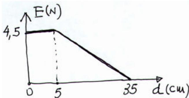
O gráfico mostra a variação do empuxo  $E$  sobre um cilindro imerso num líquido, em função do seu deslocamento vertical  $d$ .
