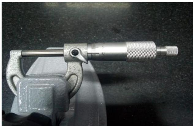
Figura 7- Micrômetro no ponto zero (Fonte: os autores)
