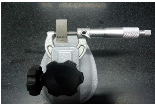
Figura 8- Micrômetro e bloco padrão (Fonte: os autores)
