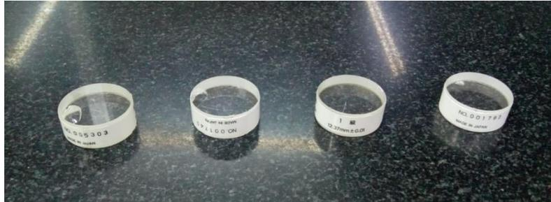
Figura 3: Conjunto de paralelos ópticos (Fonte: os autores).
