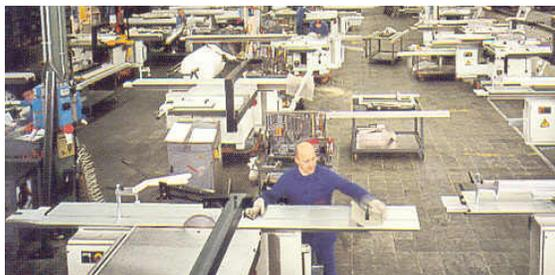
Figura 03 – Posicionamento de máquinas privilegiando o fluxo de produção.
