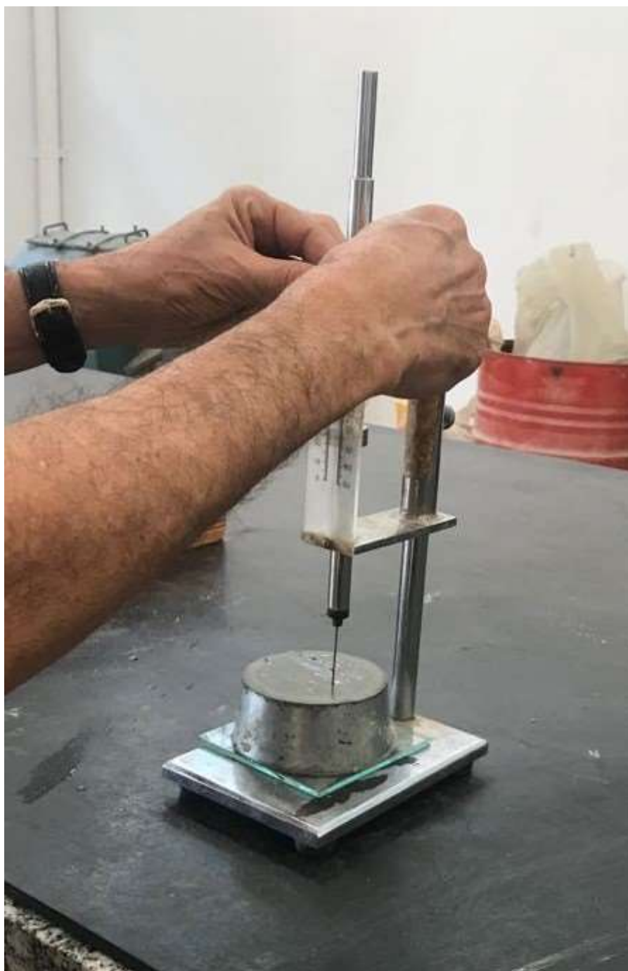
Figura 3.4 – Início de pega pelo aparelho de Vicat.
