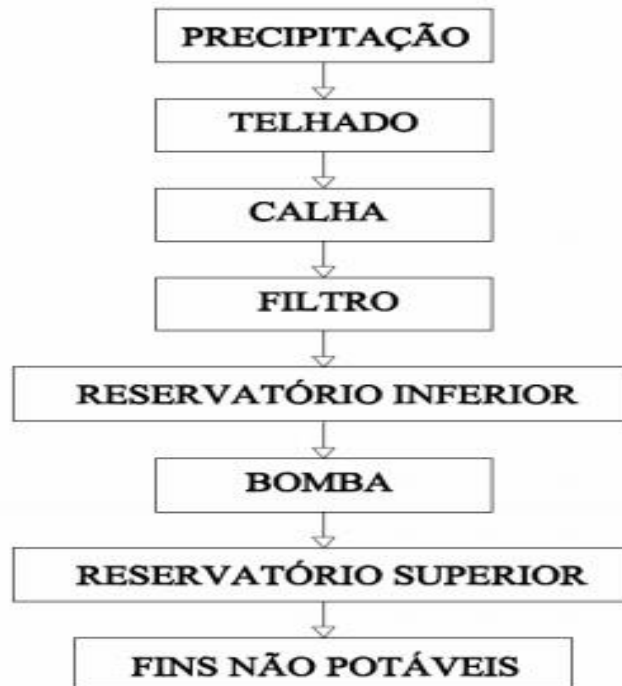
Figura 3.6: Fluxograma de um sistema de captação, armazenamento e aproveitamento de água da chuva
